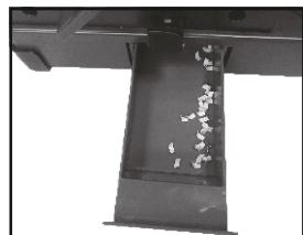
Выдвиньте лоток для бумажных отходов с левой стороны и опорожните его.
