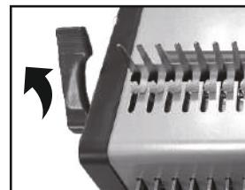
Потяните за ручку открытия пружины на себя, до тех пор, пока пружинка не раскроется в форме буквы «С».
