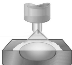
Широкая дуга, большая глубина проплавления.
