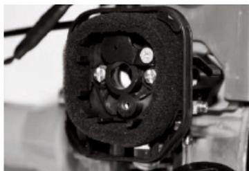
Вытащите воздушный фильтр и тщательно промойте его сначала в мыльном водном растворе, затем в чистой теплой воде. Высушите фильтр при комнатной температуре. Перед установкой фильтра пропитайте его 2-3 каплями моторного масла.
