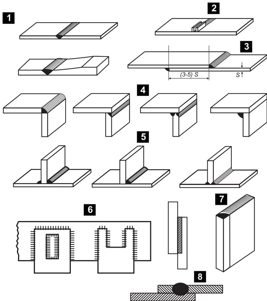
Рисунок 4 — Виды сварных соединений
