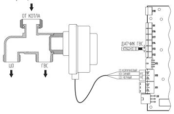
Рис.3 Схема электрического подключения
