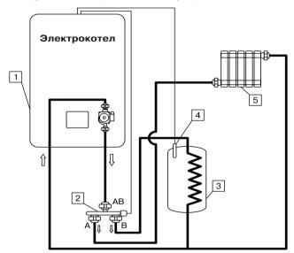
Рис.2 Гидравлическая схема подключения клапана
