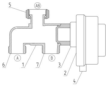
Рис.1 Устройство клапана приоритета бойлера ГВС BSR
