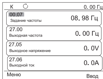
Рисунок 4.17 – Меню редактирования монитора состояния
