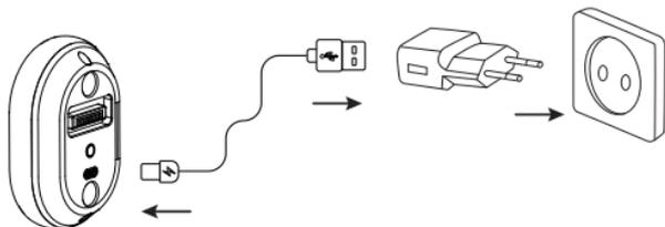
2. На аккумуляторе начнут поочередно мигать индикаторы. По мере зарядки аккумулятора индикаторы будут переставать мигать и начнут непрерывно гореть.
