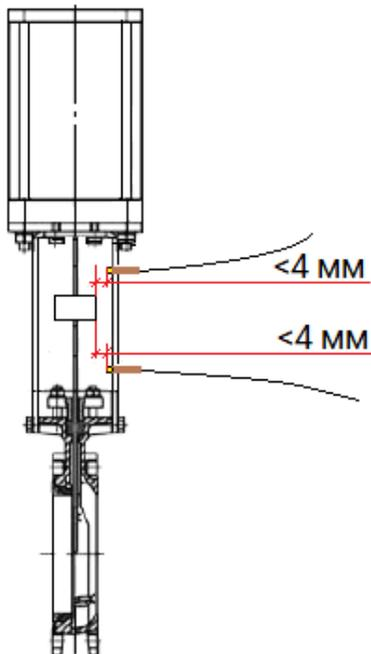
5.3. Подайте питание на датчики и проверьте их срабатывание путем открывания/закрывания задвижки.
