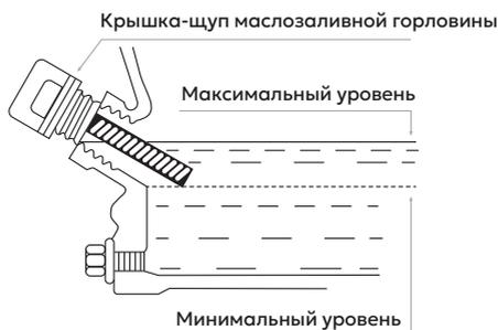
Рисунок несет ознакомительный характер. Картер выполнен схематично.
