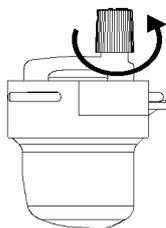
2. Вращение против часовой стрелки крана подпитки воды открывает клапан воды на заполнение
