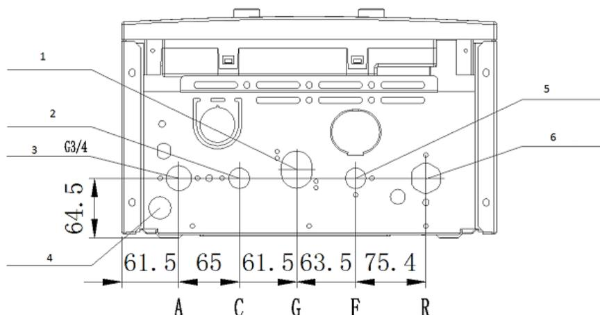
1- подвод газа G3/4; 2- патрубок подачи теплоносителя в бойлер косвенного нагрева (только модели M11TH-M40TH) G3/4; 3- патрубок подачи в контур отопления G3/4; 4- трубка слива предохранительного клапана; 5- подвод холодной воды; 6- возврат из контура отопления
