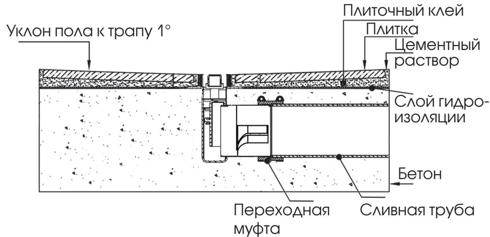
5. Подключите сливную трубу к выпуску трапа (Ø 50 мм).
