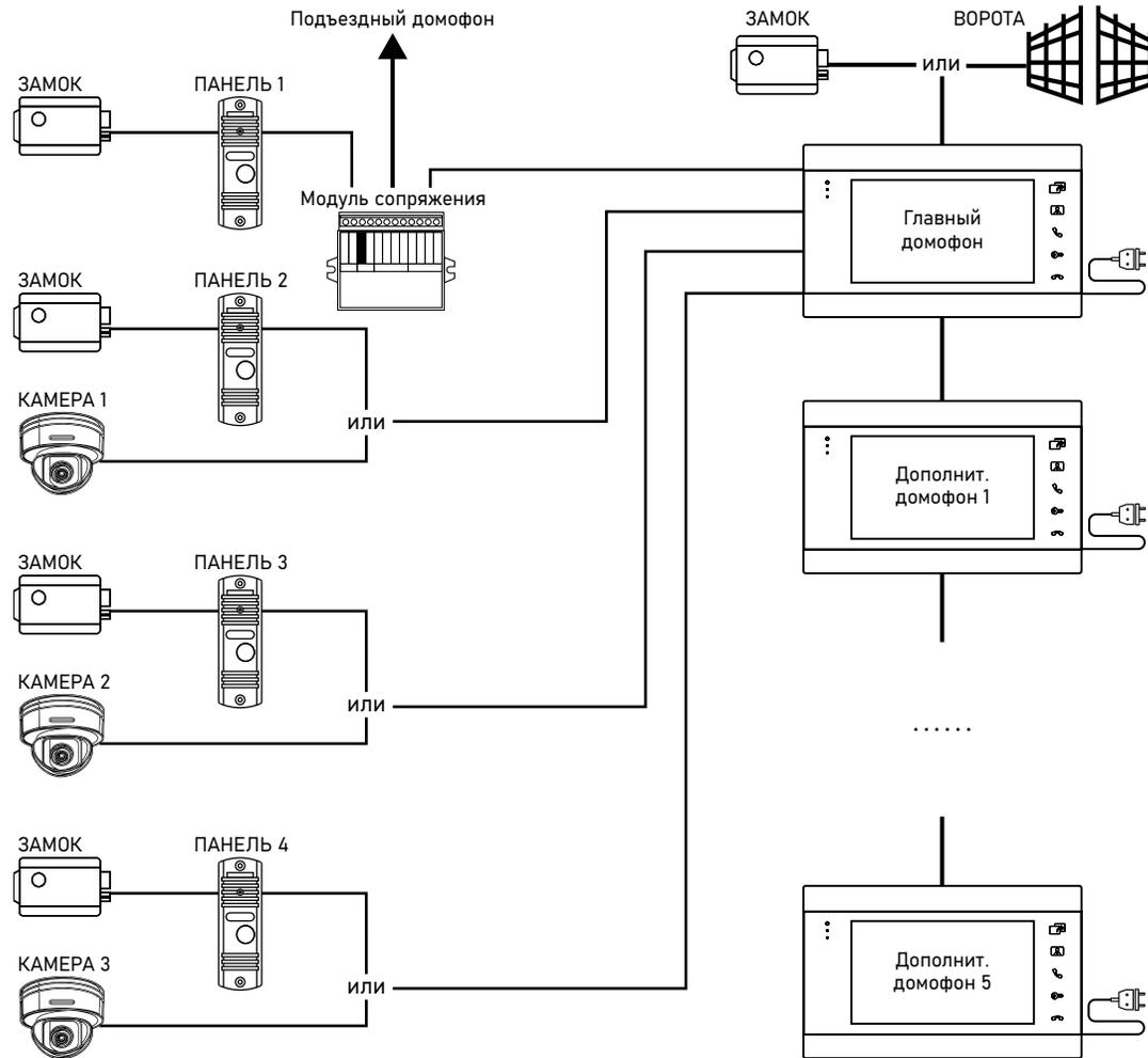
Рис. 7 Структурная схема системы на базе видеодомофонов MAGIC 7 HD
