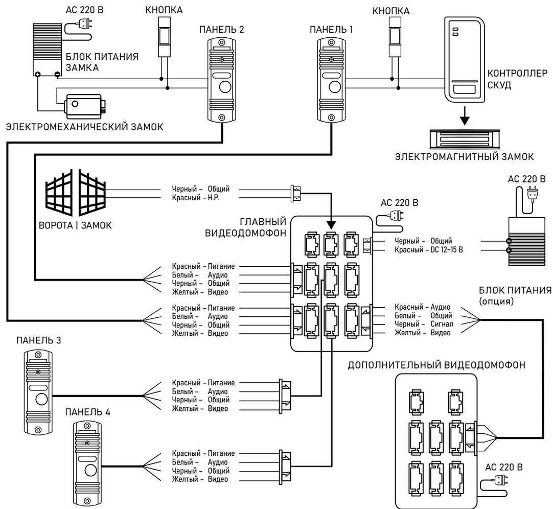
Рис. 8 Общая схема подключения видеодомофона MAGIC 7 HD
