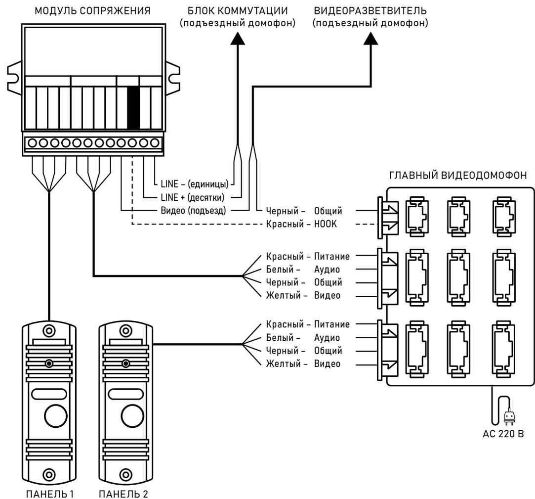
Рис. 10 Схема подключения к подъездному домофону
