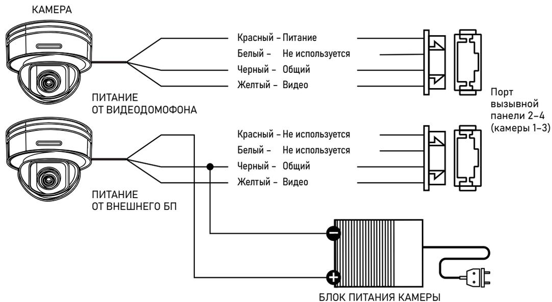
Рис. 9 Схемы подключения видеокамеры к монитору MAGIC 7 HD
