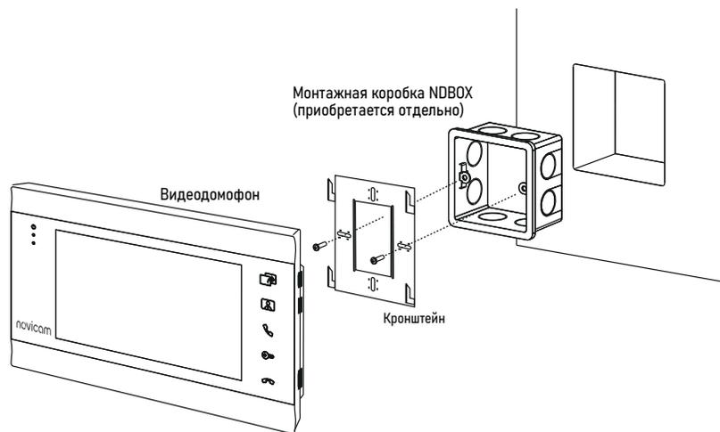
Рис. 4 Монтаж видеодомофона MAGIC 7 HD
