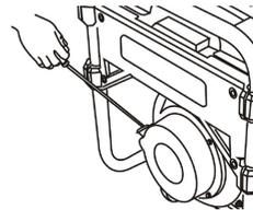
3. Установите рычаг пуска двигателя в положение «Включено» (ON).
