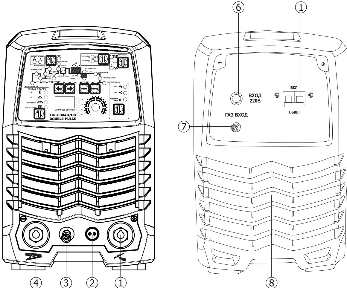
① **Выходная клемма «-».** служит для подключения аргоновой горелки
