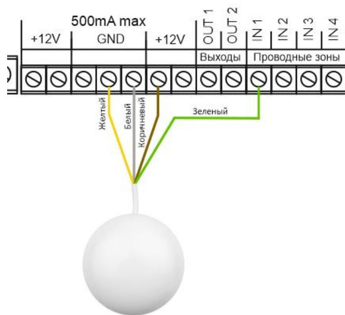
Пример подключения к устройствам: ИПРо-2, ИПРо-3, Протечек НЕТ.
