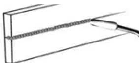
Рисунок 22. Сварка в горизонтальном положении
