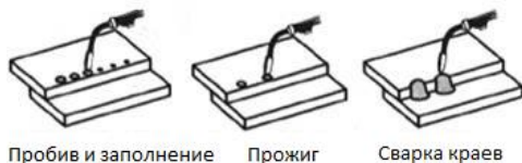
Рисунок 26. Методы MIG сварки точками.
