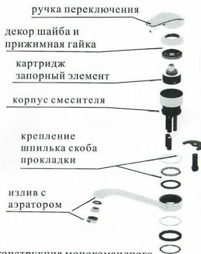
конструкция монокомандного смесителя для моек
