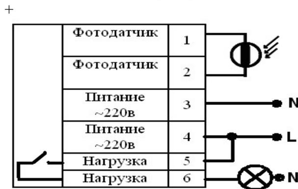
Рис.3. Типовая схема подключения фотореле к сети 220в.
