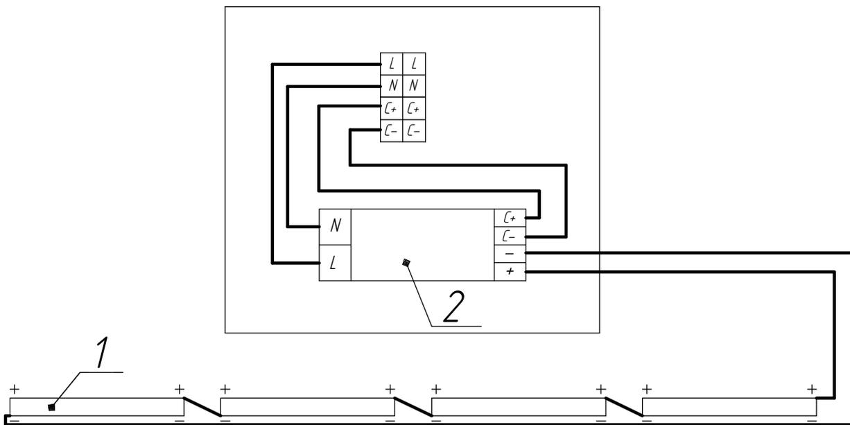
Схема 2. Электрическая ДСП65-4x9 с управлением
