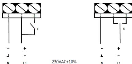
Рис. 3. СХЕМА ПОДКЛЮЧЕНИЯ ПРИВодОВ А.2х...S
