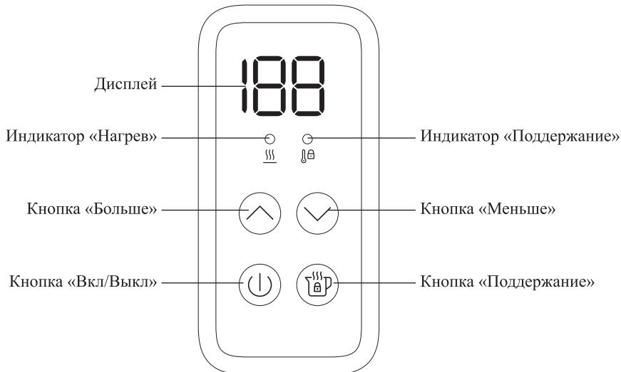
**Дисплей** отображает текущую температуру воды в чайнике, а при установке температуры — температуру нагрева и поддержания воды.
