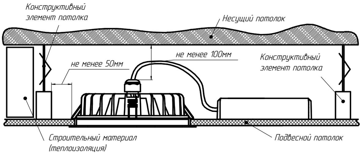
Рисунок 2а - Схема установки светильника в потолок
