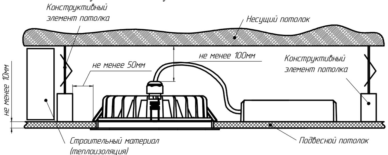
Рисунок 2б - Схема установки светильника ДВО59-35-XX5 в потолок
