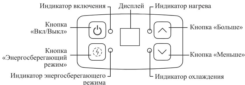
На дисплее отображается настраиваемая температура при установке и текущая температура в камере при работе устройства.
