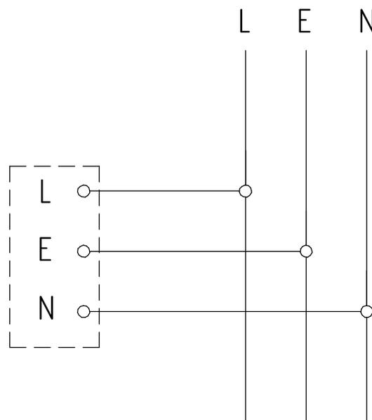
Рисунок 3 - Схема подключения к сети светильника ДСО28.
