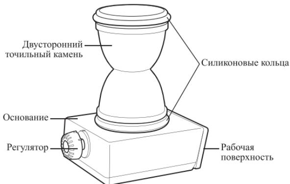
**Регулятор** служит для выбора угла заточки. При изменении регулятором угла заточки меняется наклон **рабочей поверхности**. Регулятором можно установить  $15^\circ$ ,  $20^\circ$ ,  $22^\circ$  или  $32^\circ$ . Рабочая поверхность имеет магниты для фиксации лезвия во время заточки.
