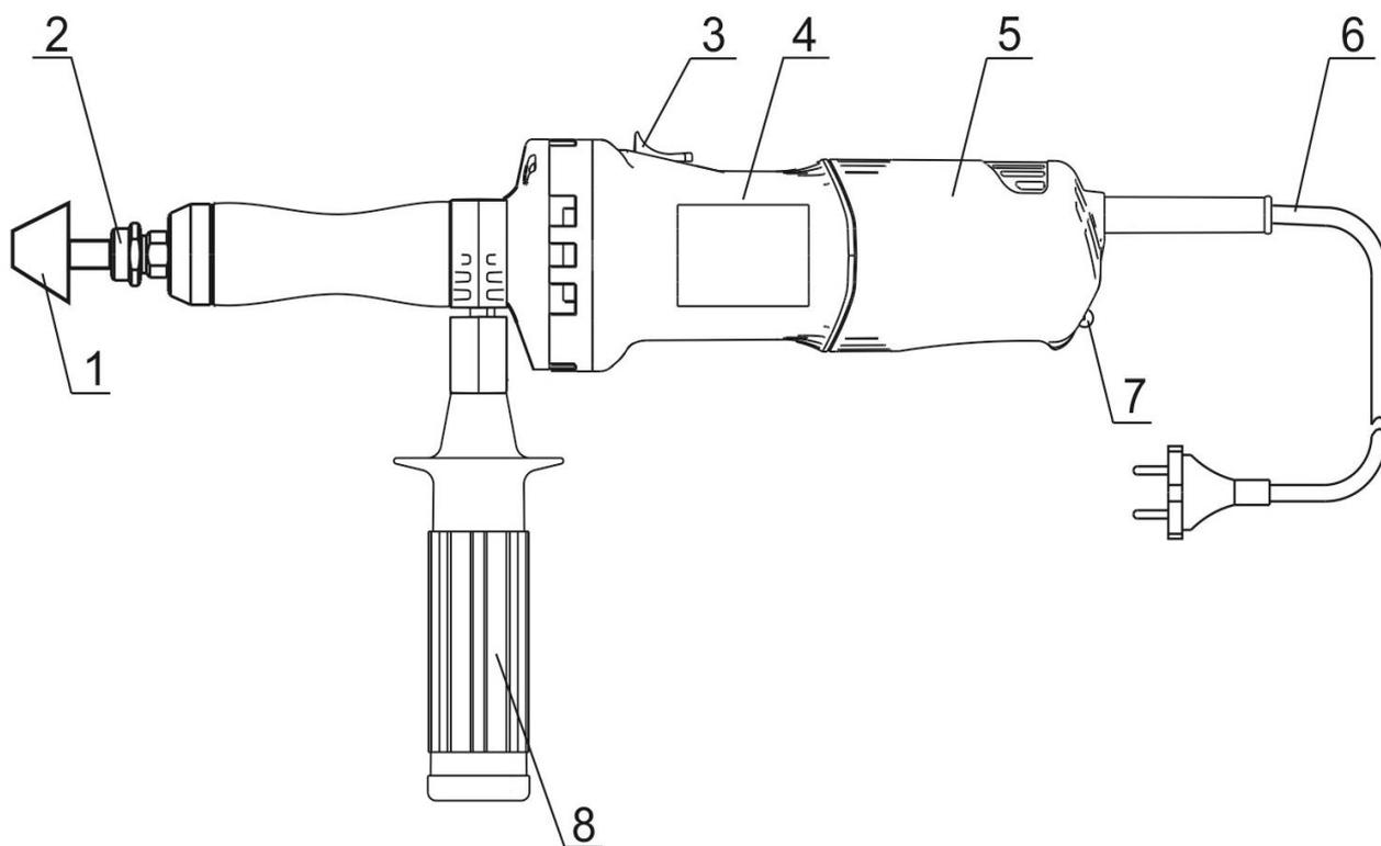
1 – абразивный инструмент; 2 – цанговый зажим; 3 – клавиша выключателя; 4 – электропривод; 5 – корпус; 6 – шнур питания; 7 – ручка электронного регулятора; 8 – ручка.
