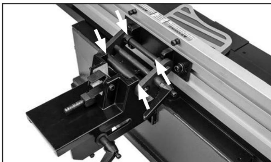
Рис. 46. Места смазки параллельного упора
