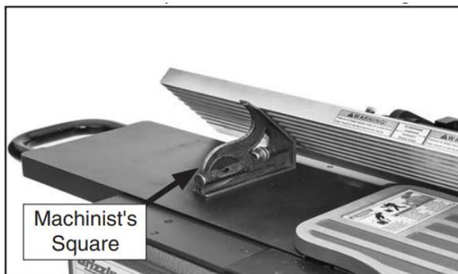
Рисунок 28. Проверка ограничителя на 45 градусов.
