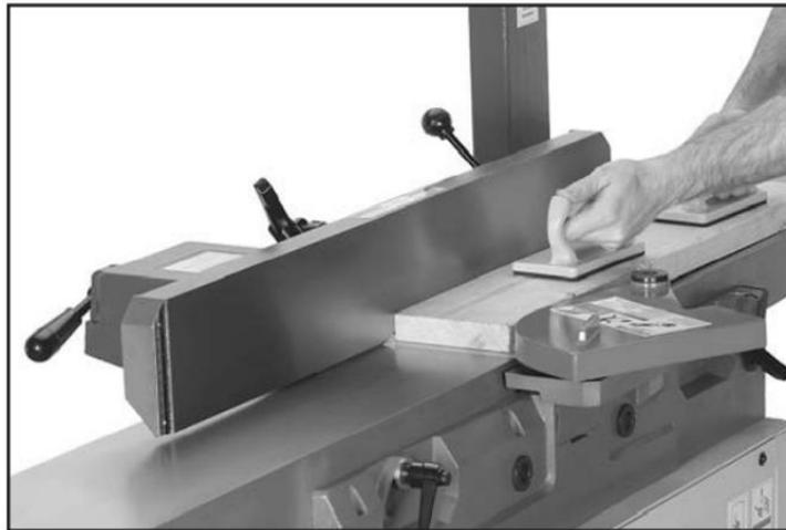
Рисунок 34. Пример выравнивания поверхности
