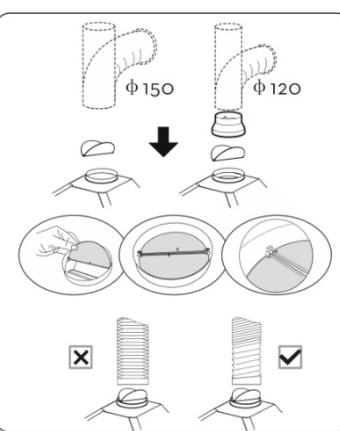
Воздух удаляется из помещения через соединение вытяжки с вентиляционным каналом жестким пластиковым воздуховодом или гофрированным шлангом. И, таким образом, все кухонные испарения выводятся за пределы помещения. При данном режиме работы нет необходимости устанавливать угольные фильтры. Режим отвода является наиболее эффективным, поскольку вытяжка удаляет все кухонные испарения за пределы кухни в вентиляционную шахту.
