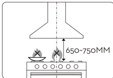
**Внимание:** вытяжку следует размещать на расстоянии 650–750 мм над варочной панелью.
