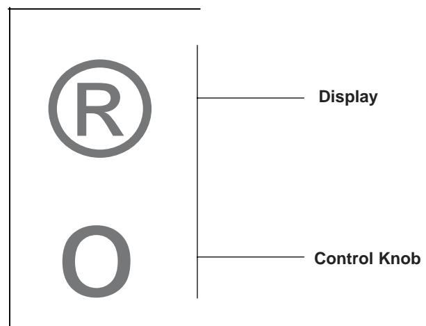
**Control Knob – Ручка управления:** Когда вы вращаете ручку по часовой стрелке; ваше устройство начинает работать, и если вы продолжите вращать, скорость работы увеличивается. Когда вы поворачиваете ручку против часовой стрелки, ваше устройство продолжает сокращать количество циклов и в конечном итоге отключается. Вы можете включить подсветку в зоне приготовления пищи, нажав ручку управления.
