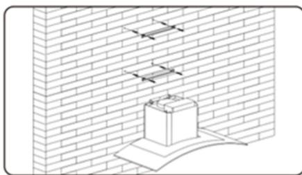
Отметьте положение и просверлите по 2 отверстия для каждого кронштейна и закрепите кронштейн.
