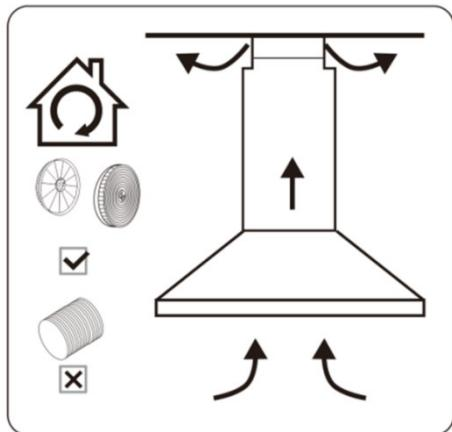
Вытяжка в данном случае не подключается к вентиляционной шахте и, таким образом, воздух просто прогоняется через вытяжку внутри кухни.
