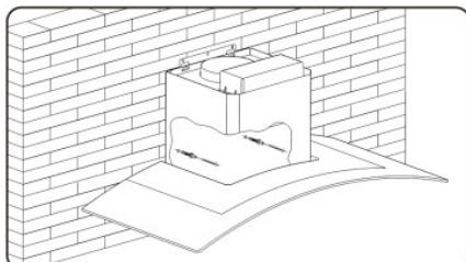
Просверлите 2 дополнительных отверстия Ø8 мм и закрепите вытяжку к стене с помощью дюбелей и саморезов.
