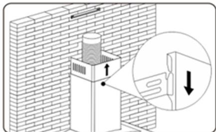
Вставьте верхнюю часть кожуха в нижнюю часть кожуха, а затем вытяните верхний кожух вверх до необходимой высоты.
