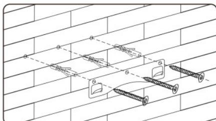
Просверлите 3 отверстия Ø8 мм.
