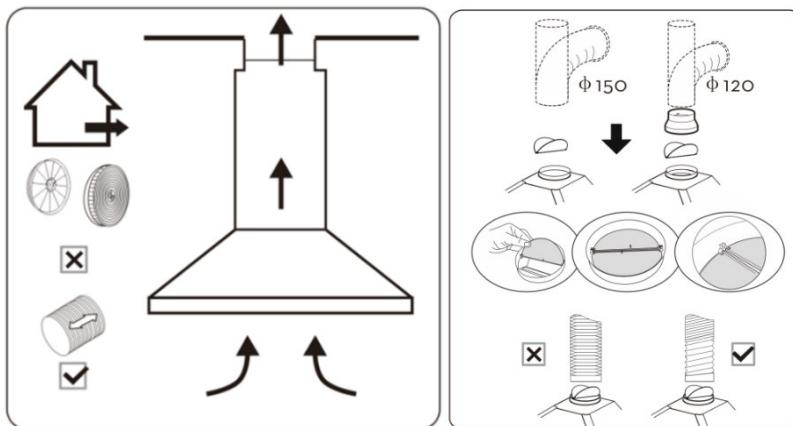
Воздух удаляется из помещения через соединение вытяжки с вентиляционным каналом жестким пластиковым воздуховодом или гофрированным шлангом. И, таким образом, все кухонные испарения выводятся за пределы помещения. При данном режиме работы нет необходимости устанавливать угольные фильтры. Режим отвода является наиболее эффективным, поскольку вытяжка удаляет все кухонные испарения за пределы кухни в вентиляционную шахту.
