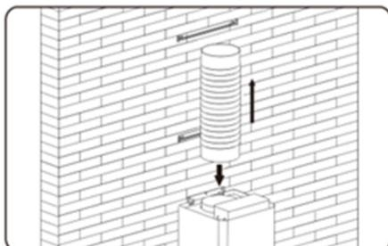
Прикрепите обратный клапан к выпускному отверстию вытяжки, а затем прикрепите гофрированный воздуховод, как показано на рисунке.
