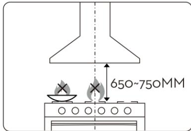
**Внимание:** вытяжку следует размещать на расстоянии 650–750 мм над варочной панелью.
