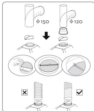
Воздух удаляется из помещения через соединение вытяжки с вентиляционным каналом жестким пластиковым воздуховодом или гофрированным шлангом. И, таким образом, все кухонные испарения выводятся за пределы помещения. При данном режиме работы нет необходимости устанавливать угольные фильтры. Режим отвода является наиболее эффективным, поскольку вытяжка удаляет все кухонные испарения за пределы кухни в вентиляционную шахту.
