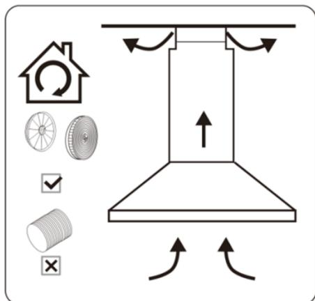
Вытяжка в данном случае не подключается к вентиляционной шахте и, таким образом, воздух просто прогоняется через вытяжку внутри кухни. В режиме рециркуляции на вытяжку должны быть установлены угольные фильтры CF230-2. Эти фильтры не входят в комплект вытяжки и приобретаются отдельно. Угольные фильтры следует менять не реже, чем раз в 3-4 месяца (в зависимости от интенсивности приготовления пищи).
