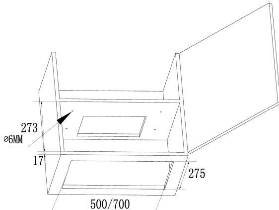
Положение монтажных отверстий на корпусе:
