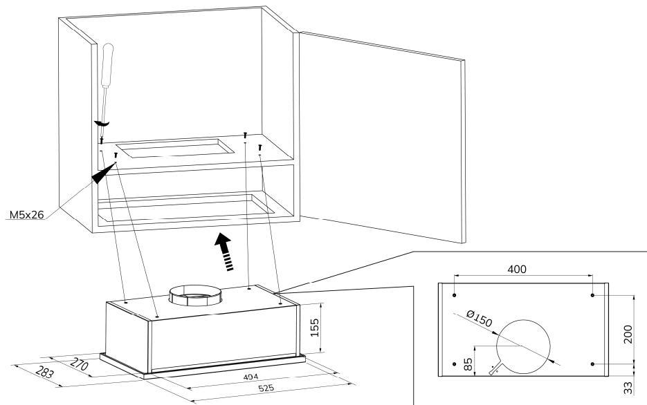
1. Вырежьте отверстие в нижней панели шкафа, в соответствии с размерами корпуса вытяжки.
