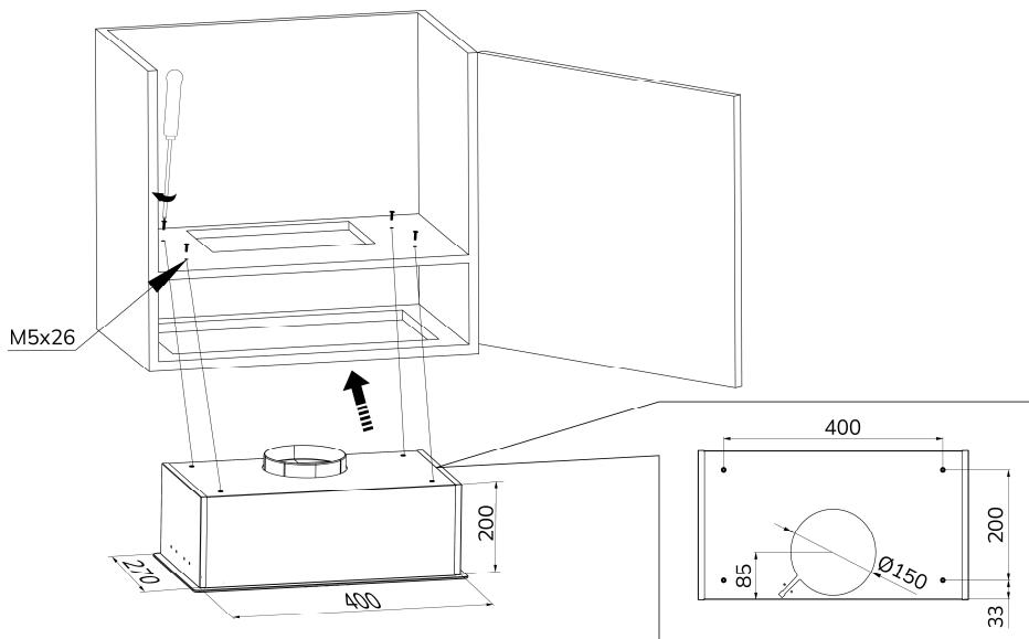
1. Вырежьте отверстие в нижней панели шкафа, в соответствии с размерами корпуса вытяжки.
