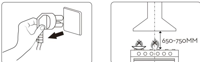
**Внимание:** вытяжку следует размещать на расстоянии 650–750 мм над варочной панелью.
