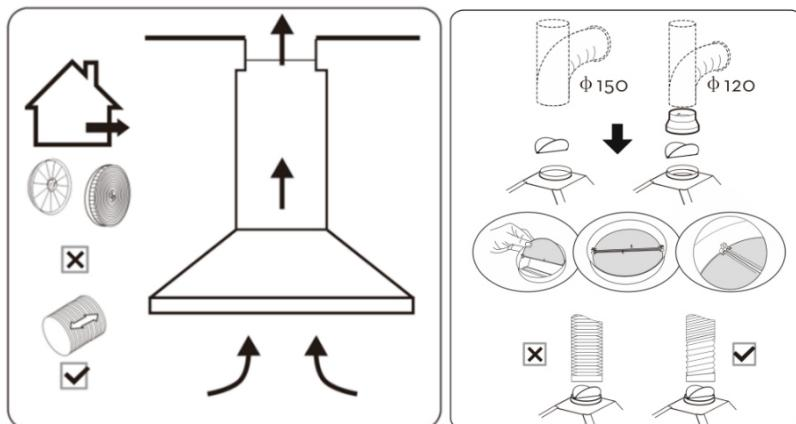
Воздух удаляется из помещения через соединение вытяжки с вентиляционным каналом жестким пластиковым воздуховодом или гофрированным шлангом. И, таким образом, все кухонные испарения выводятся за пределы помещения. При данном режиме работы нет необходимости устанавливать угольные фильтры. Режим отвода является наиболее эффективным, поскольку вытяжка удаляет все кухонные испарения за пределы кухни в вентиляционную шахту.
