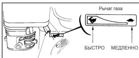
Рис.16 Установка рычага газа
