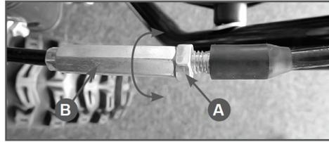
**Рис.21** Регулировка троса включения шнека
