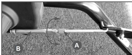
**Рис.20** Регулировка троса привода хода
