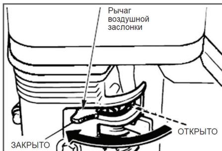
Рис.15 Установка рычага воздушной заслонки
