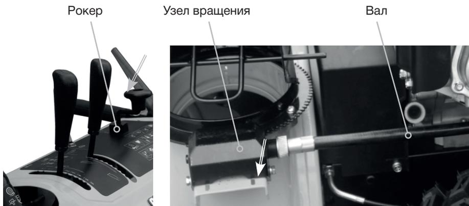
4. Установка желоба: сначала открутите желоб, закреплённый болтом, установите его на посадочное место так, чтобы совпали отверстия для болтов и плотно затяните при помощи болта.
