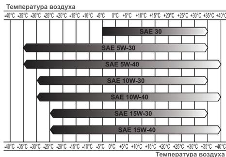
Рис.12 Таблица выбора моторного масла
