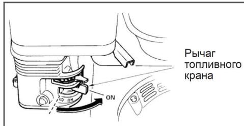
Рис.15 Открытие топливного крана
