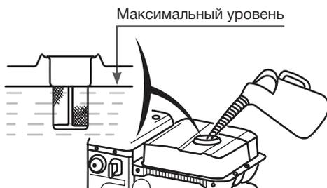
**Рис.11** Максимальный уровень топлива в баке
