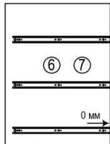
Направляющие к боковине крепятся по третьим отверстиям от края направляющей (или 17 или 0 мм от торца боковины до начала направляющей)
