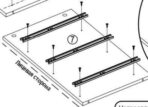
На боковине необходимо провести линию между разметкой под направляющие, выровнять направляющую по переднему краю отступив 17 или 0 мм от переда и закрутить саморезы по линии
