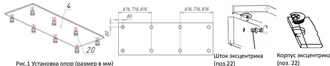
Рис.1 Установка опор (размер в мм)
