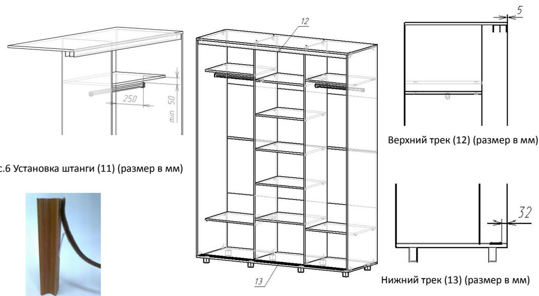
Рис.6 Установка штанги (11) (размер в мм)
