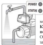
Системе нужна вода. Один или несколько кранов включены. Устройство EASY PRESS® обнаруживает поток; давление в системе, как правило, выше, чем ПУСКОВОЕ давление, но может быть и ниже.
