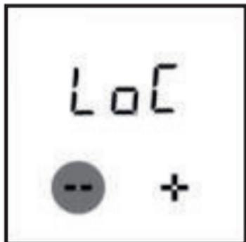
При наличии детей или при установке терморегулятора в публичном месте, вы можете заблокировать дисплей терморегулятора. Эта функция не позволит изменять заданную температуру. Для активации нажмите и удерживайте кнопку «-» в течение 3-х секунд, до появления надписи «LoC». После этого на дисплее продолжит отображаться текущая температура, измеренная датчиком. При
