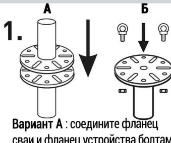
Вариант А : соедините фланец сваи и фланец устройства болтами и гайками.
