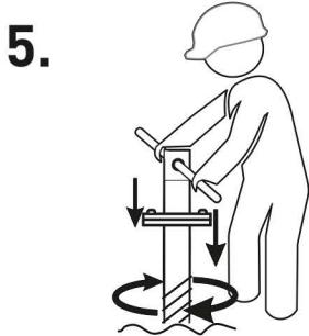
Равномерно распределяйте усилия на оба рычага ключа, если монтируете один
