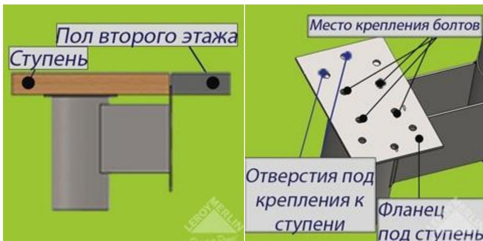
5) Раздвигайте каркас, придавая лестнице необходимую форму и конфигурацию, поворачивая стаканы друг относительно друга. При использовании в конструкции поворота на  $90^\circ$  угол поворота каждого модуля, участвующего в повороте, должен составлять  $30^\circ$ .
