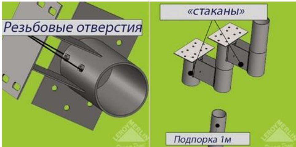
4) Закрепите верхний модуль к перекрытию таким образом, чтобы верхняя ступень встала в уровень пола верхнего этажа
