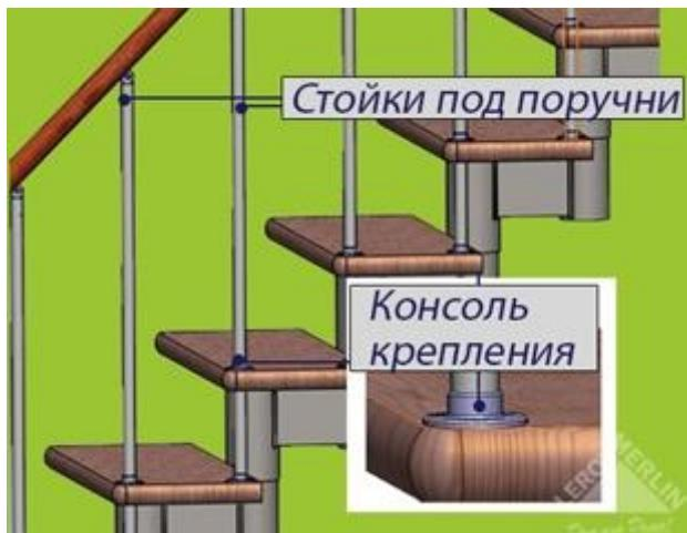
2) На каждую ступень установите хромированную консоль крепления, идущую в комплекте со стойкой. Если вы приобрели деоративные крышки на консоли, то также закрепите их поверх консолей крепления.
