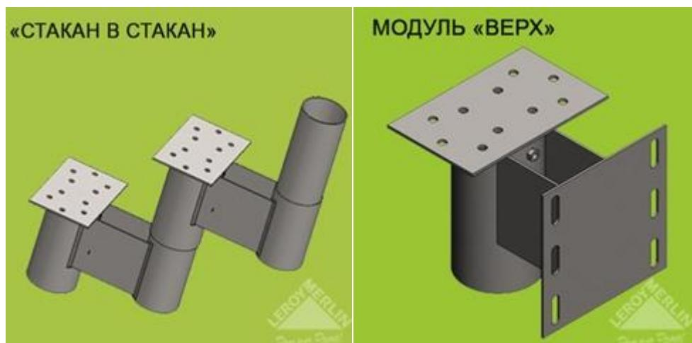
3) Подпорка вставляется в нижнюю часть подходящего среднего модуля. Подпорка и модуль просверливаются насеквоздь и фиксируются 2-3 саморезами 6-8 мм. Конструкция должна стать устойчивой.
