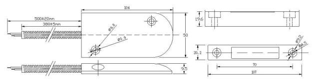
Извещатель магнитоконтактный ST-DM146NC-SL предназначен для контроля положения различных строительных конструкций (дверей, окон, люков, ворот и т.д.). Данное устройство может использоваться в системах охранной сигнализации или контроля и управления доступом.
