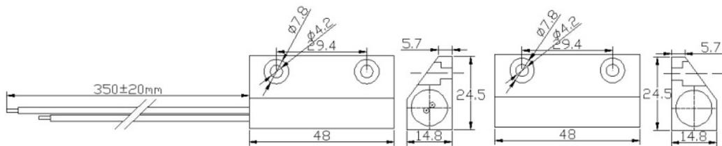
Извещатель магнитоконтактный ST-DM131NO-SL предназначен для контроля положения различных строительных конструкций (дверей, окон, люков, ворот и т.д.). Данное устройство может использоваться в системах охранной сигнализации или контроля и управления доступом.
