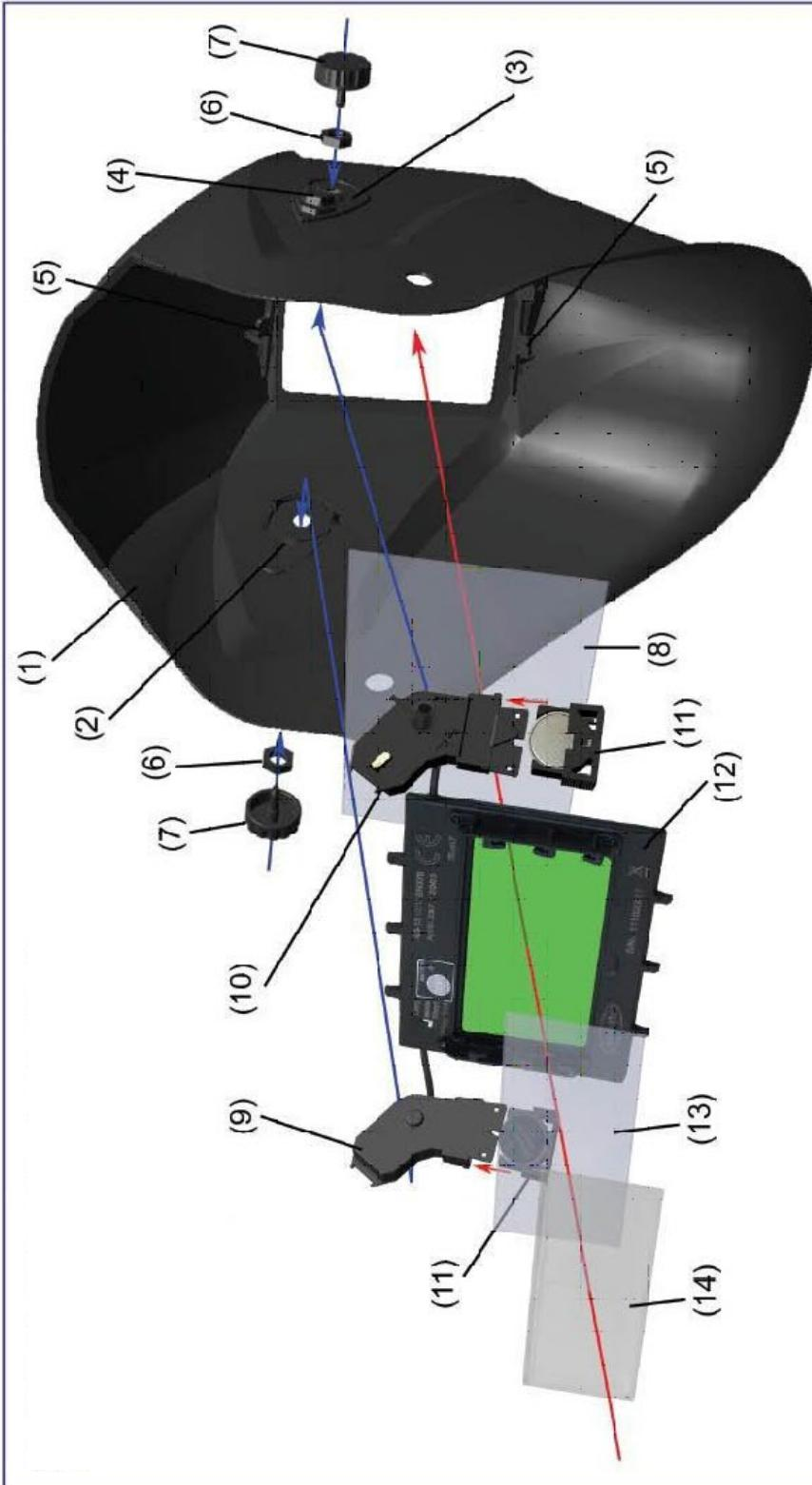
1. Каркас маски 2. Регулятор затемнения 3. Регулятор чувствительности 4. Ручка сварки/заточка 5. Фиксирующая рамка для фильтра 6. Болт фиксации 7. Ручка настройки затемнения/чувствительности 8. Наружное защитное стекло 9. Блок регулировки затемнения 10. Блок регулировки чувствительности 11. Гнездо для литиевой батареи 12. Фильтр-хамелеон 13. Внутреннее защитное стекло 14. Увеличительная линза (опция)
