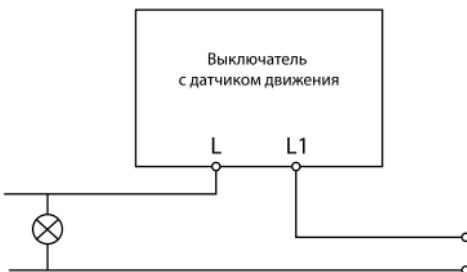
Рисунок 1. Схема подключения
