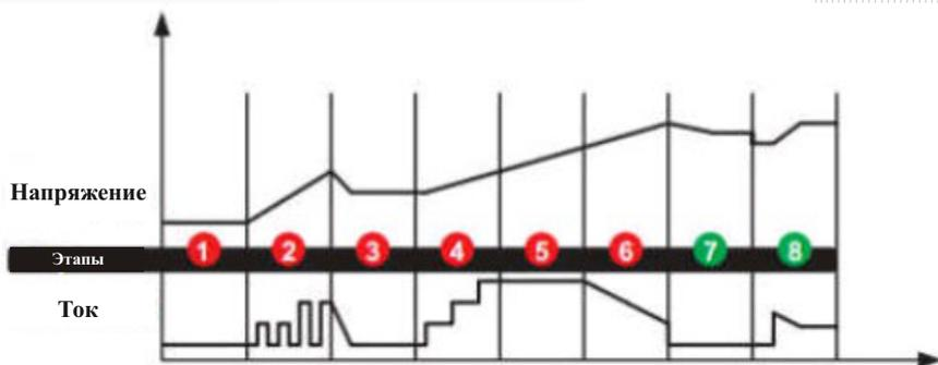
**ЭТАП 1: ДИАГНОЗ** (Проверьте, подключен ли аккумулятор к зарядному устройству, а также проверьте напряжение аккумулятора)
