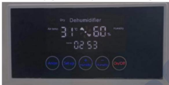
При нажатии кнопки ON/OFF («ВКЛ/ВЫКЛ») осушитель воздуха включается и на дисплее появляется надпись Run («Работает»). При повторном нажатии кнопки ON/OFF («ВКЛ/ВЫКЛ») осушитель выключается, а надпись DRY («Работает») исчезает. Если компрессор какое-то время работает, а затем выключается, это значит, что он оснащен 3-минутной защитной задержкой. То есть компрессор будет работать 3 минуты после очередного включения.
