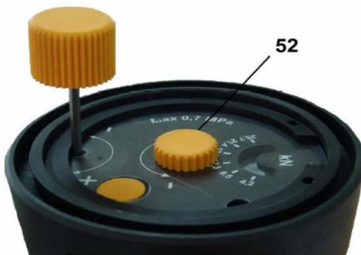
Если возникает проблема с установкой давления, отключите устройство от подачи сжатого воздуха для сброса давления.
