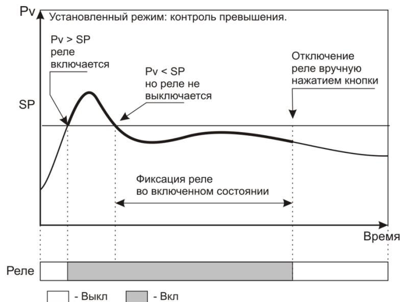
Возможна конфигурация прибора, при которой состояние аварии фиксируется в энергозависимой памяти прибора. В этом случае, если после срабатывания реле произойдёт отключение напряжения питания прибора, то после возобновления питания и включения прибора реле снова включится. Выключится оно только после нажатия на кнопку «□».
