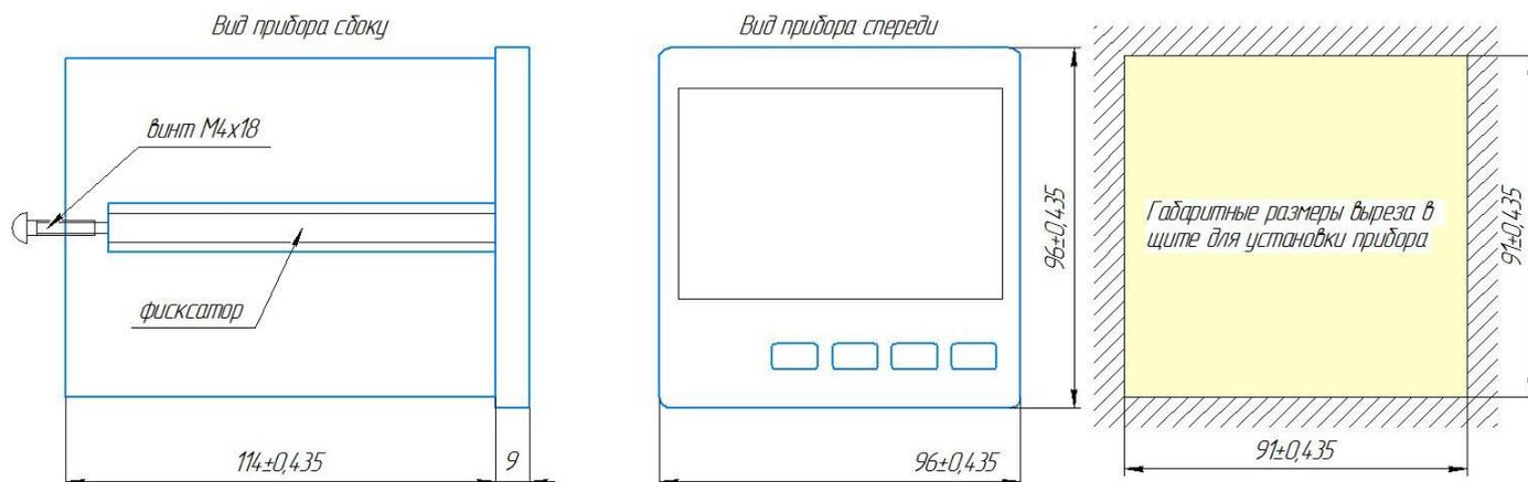
Размер отверстия в щите под прибор должен быть не более чем 91x91 мм. Крепежные винты затягивать без усилия, в противном случае возможен отход и поломка пластиковой передней панели, что является **не гарантийным** случаем при ремонте.
