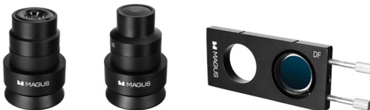
**Фазово-контрастное устройство** используется для наблюдения малоконтрастных объектов, которые отличаются от окружающей среды только показателем преломления. Такие объекты вносят исключительно фазовые изменения, и поэтому невидны в светлом поле. Фазово-контрастная микроскопия превращает невидимые фазовые изменения в амплитудные, различимые глазом. Главное преимущество метода заключается в исследовании живых неокрашенных организмов в естественном состоянии.
